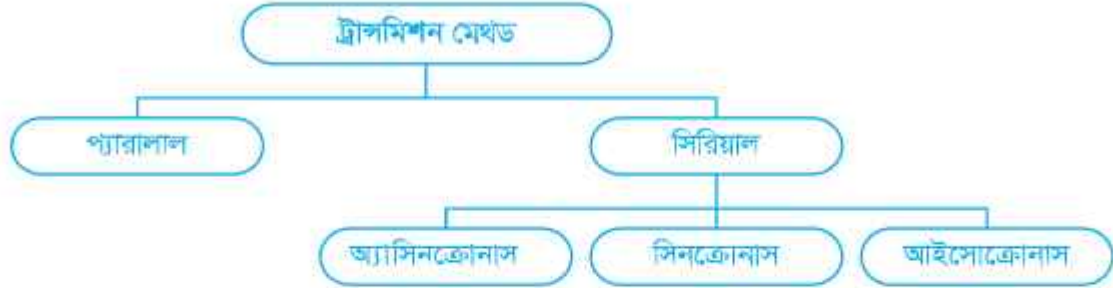
চিত্র 2.3: তিন ধরনের সিরিয়াল ডেটা কমিউনিকেশন
